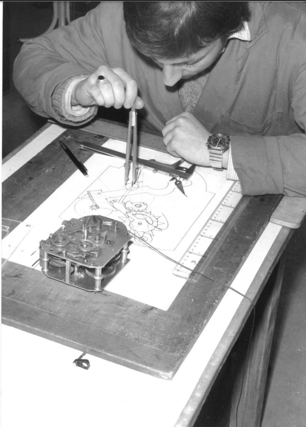
Traçage à la planche à dessin des formes et dimensions des pièces manquantes de la cadrature d'une sonnerie sur un mouvement de pendule anglaise.
