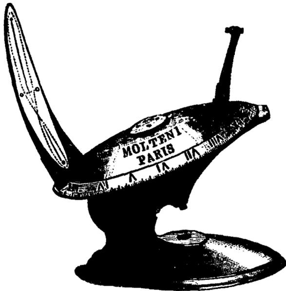
Fig. 7. — Chronomètre solaire Fléchet.
